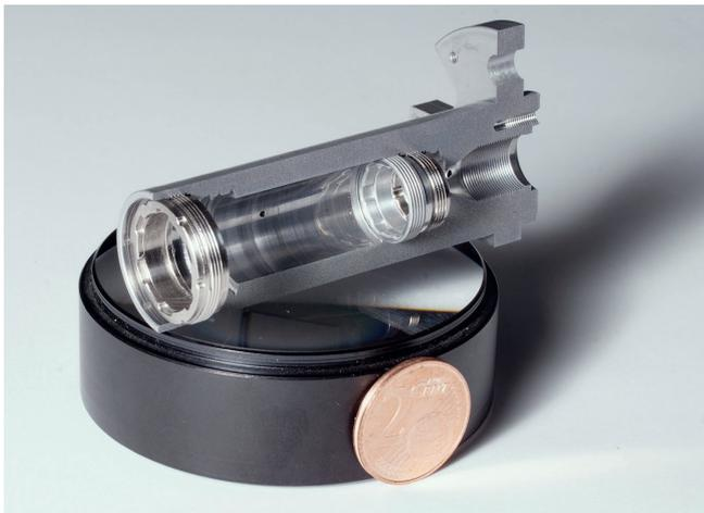
**3** Teleskop für einen Kommunikationssatelliten im Schnitt: Dieses optische Bauelement sowie Einzelteile, wie etwa ein Ring zur Kompensation thermischer Ausdehnung, fräst Cemec auf der Kern Micro HD reproduzierbar bis auf weniger als 1 µm genau © Cemec
